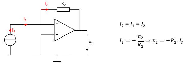
Pourquoi ne pas avoir réalisé la conversion courant tension à l'aide d'une simple résistance, puisque, par application de la loi d'Ohm, on aurait directement :
